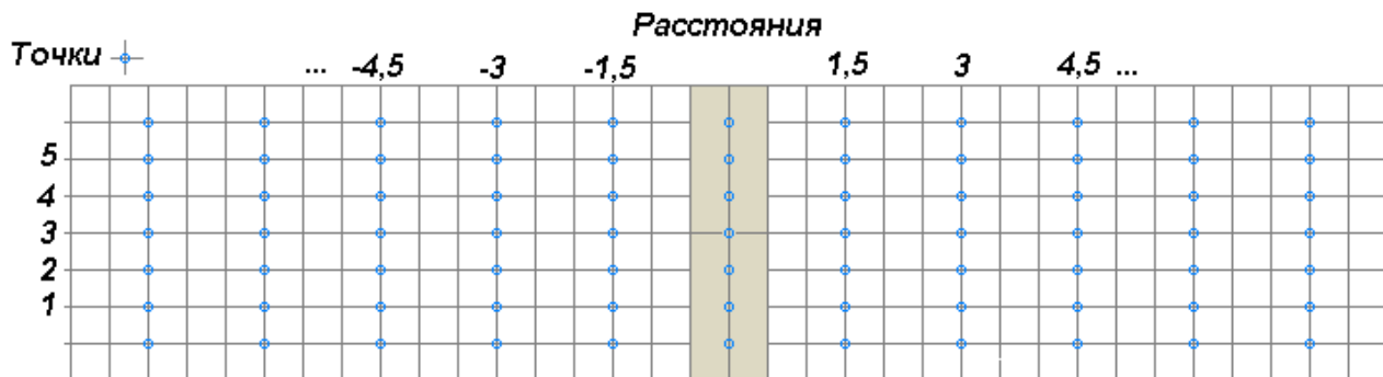
Рисунок П2 - Схема нанесения разметки при проверке ровности дорожного покрытия в поперечном направлении
